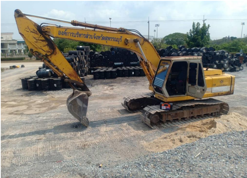
รถคันที่ 2 รถขุดไฮดรอลิก ค้ำไต้ HD 700 ต-2400
